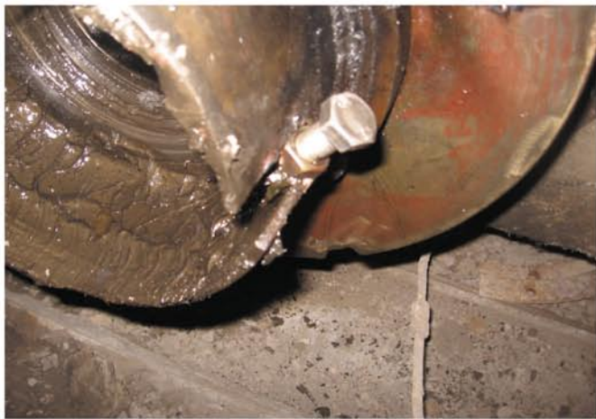
Rys. 4. Pojedyncza śruba przekazująca moment obrotowy z nakrętki brązowej na nakrętkę stalową. Widać jak wysunęła się z prowadnicy i poluźniła nakrętkę stalową, która przestała się w związku z tym przesuwać po śrubie
