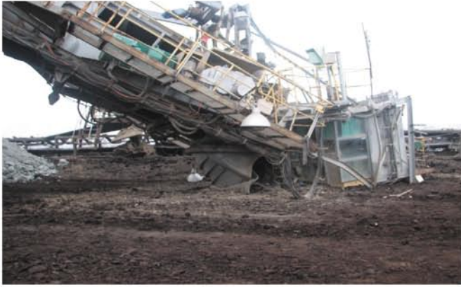
Rys. 2. Efekt awarii mechanizmu zwodzenia końcówki wysięgnika odbierającego
