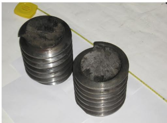
Rys. 7. Oba fragmenty rozerwanej śruby w miejscu przełomu
