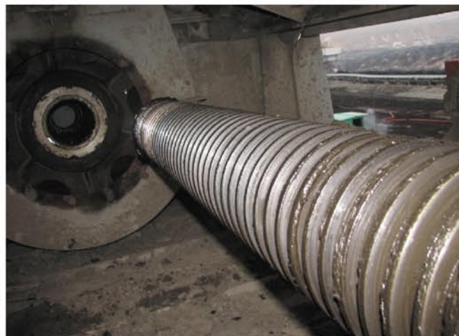
Rys. 5. Urwana śruba napędu mechanizmu zwodzenia wychylnej końcówki wysięgnika
