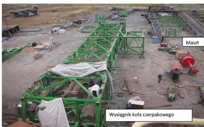
Rys. 15. Modernizacja wysięgnika koła czerpakowego Fig. 15. Modernization of bucket wheel outrigger
