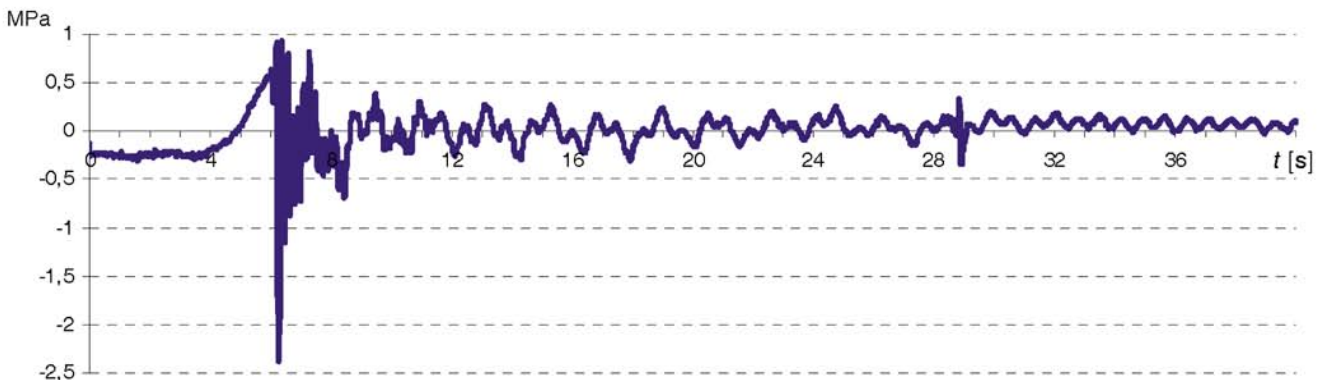
Rys. 3. Przebiegi czasowe drgań swobodnych koparki Fig. 3. Time course of excavator free vibrations
