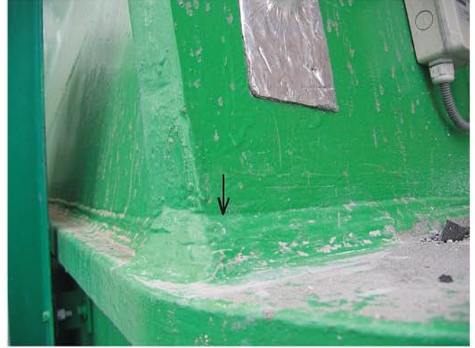
Rys. 11. Miejsce potencjalnego pęknięcia wytypowane do analizy lokalnej Fig. 11. Area of potential cracking chosen for local analysis
