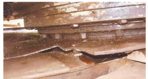
Rys.3. Portowy żuraw wypadowy. Struktura kosztów wytwarzania. Skutki awarii spowodowanej pęknięciem zmęczeniowym
