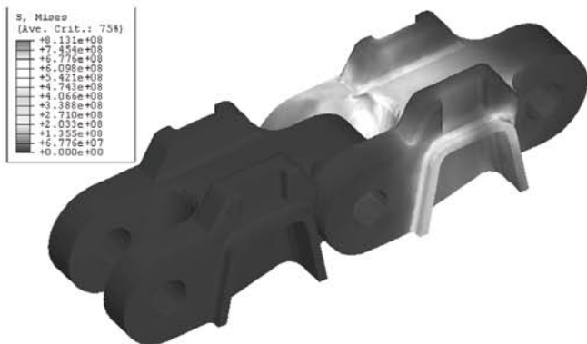
Rys. 4. Rozkład naprężeń zredukowanych w parze ogniw po zastosowaniu modyfikacji I i II (opis w tekście)
