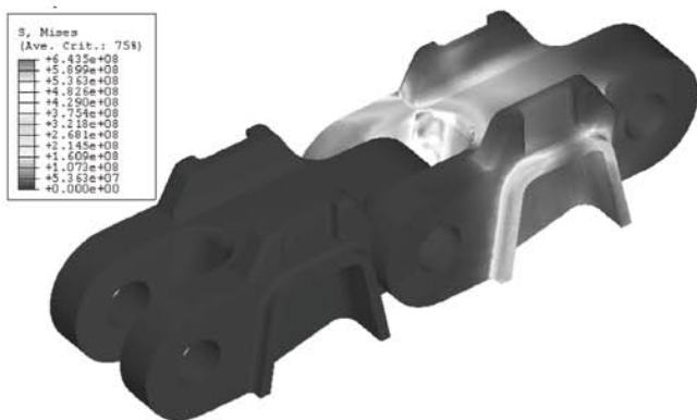
Rys. 5. Rozkład naprężeń zredukowanych w parze ogniw po zastosowaniu modyfikacji I, II i III (opis w tekście)
