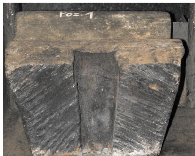
Rys.1. Próbka 1. Makroskopowy obraz stanu powierzchni roboczej szczęki kruszarki do kruszenia skały o kubaturze 10-1000 mm.
