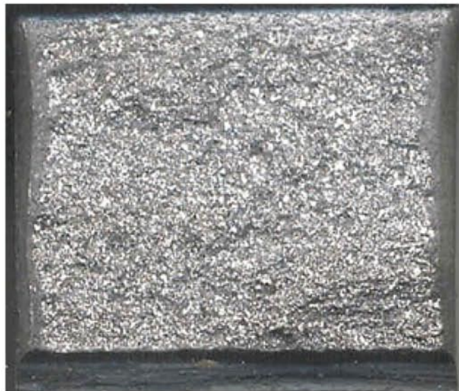
Rys. 17. Obraz makroskopowy przelomu stali gatunku B27 – stan po normalizowaniu. Temp. badania 0°C
