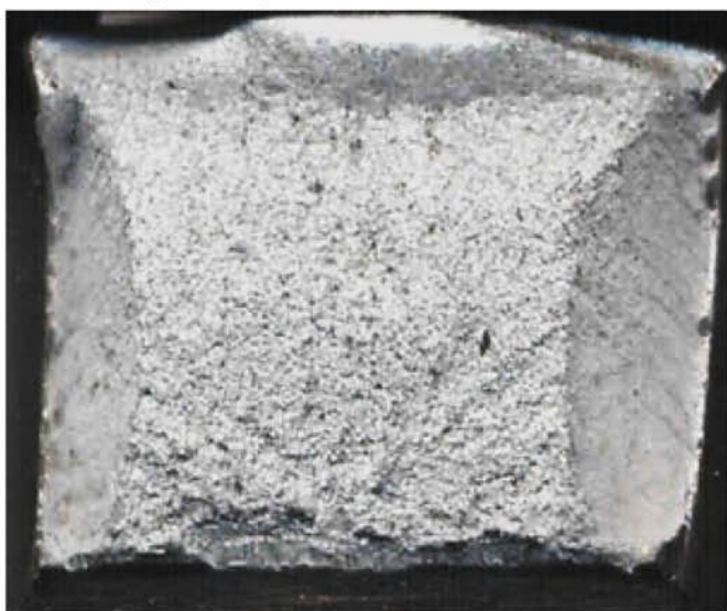
Rys. 19. Obraz makroskopowy przelomu stali gatunku B27 – stan po hart/odp. Temp. badania 20°C
