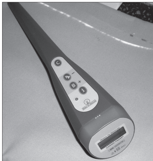
Fot. 1 Miniaturowy przenośny miernik promieniowania \gamma (Gamma Finder, World of Medicine AG, Ludwigsstadt, Niemcy) stosowany w radiomapowaniu nuklearnym w paratyreoidektomii
