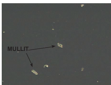
Rys. 14. Obraz mikroskopowy popiołu po syntezy z NaCl; światło przechodzące, skrzyżowane nikole, powiększenie 200×
