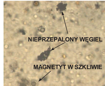
Rys. 4. Obraz mikroskopowy popiołu, próbka PE; światło przechodzące, równoległe nikole, powiększenie 400×
