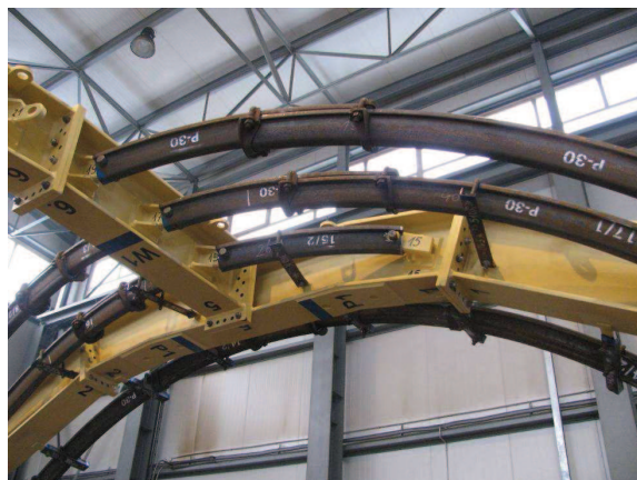
Fot. 1. Fragment obudowy odgałęzienia portalowego podczas próbnego montażu
