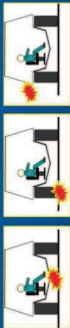
Rys. 4. Wymaganie emulodporności oraz odłamkodporności pojazdów według umowy standardyzacyjnej STANAG 4569
