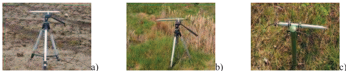
Rys. 4. Czujniki ciśnienia PCB Piezotronics Inc. serii 138a zastosowane w badaniach doświadczalnych do identyfikacji parametrów fali uderzeniowej wybuchu
