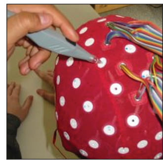
Rys. 10 Digitalizacja elektrod czepka wieloelektrodowego [31] Źródło: opracowanie własne
