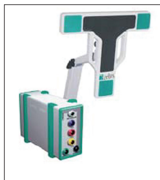
Rys. 2 Odbiornik i jednostka podstawowa systemu Zebris [27, 28] Źródło: http://www.zebris.de/deutsch/pdf/d_produkinfo_ElGuide_1.pdf
