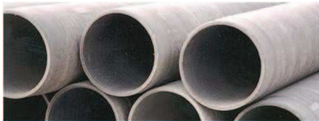
Fot. 1. Rury azbestowo-cementowe (Wesołowski 2005)
