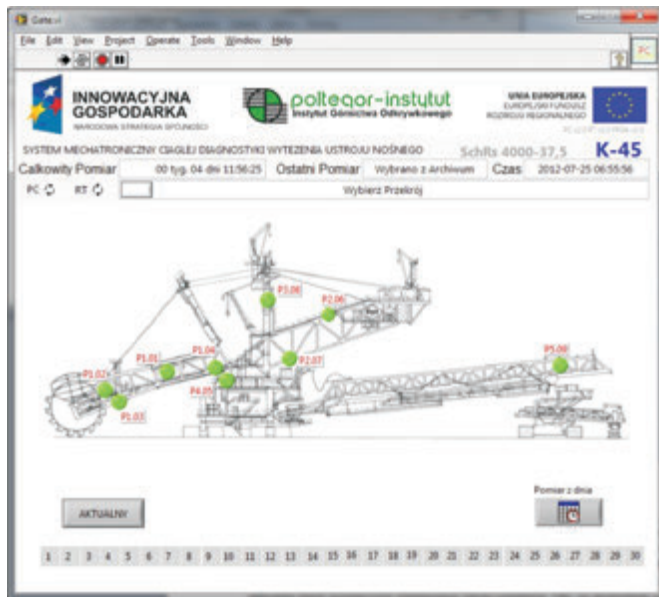
Rys. 2 Koparka SchRs 4000 z zaznaczonymi punktami pomiarowymi Fig. 2. Marked measuring points on the bucket wheel excavator SchRs 4000
