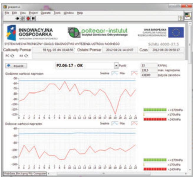
Rys. 13. Przykładowe przebiegi i wartości zarejestrowanych naprężeń na przeciwwadze Fig. 13. Test runs and values of recorded stresses on counterweight jib
