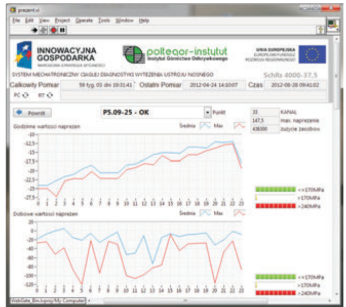
Rys. 14. Przykładowe przebiegi i wartości zarejestrowanych naprężeń na moście podającym Fig. 14. Test runs and values of recorded stresses on connecting bridge
