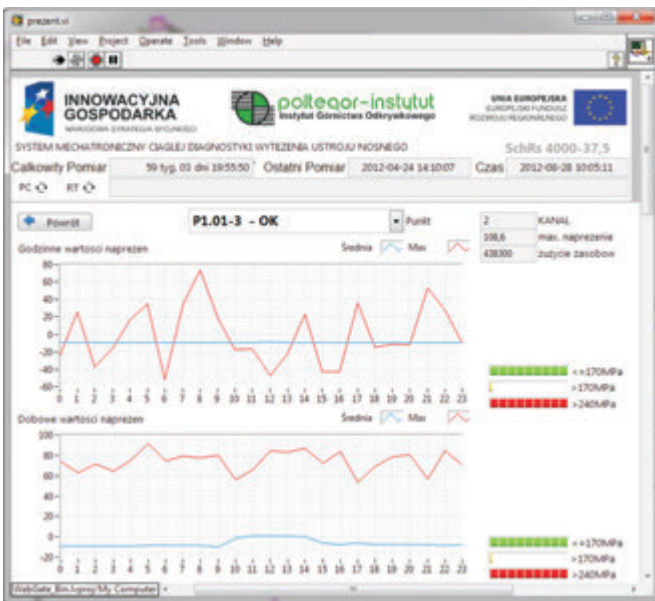
Rys. 12. Przykładowe przebiegi i wartości zarejestrowanych naprężeń na wysięgniku koła czerpakowego Fig. 12. Test runs and values of recorded stresses on bucket wheel boom
