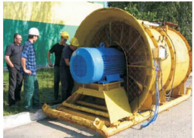
Rys. 6. Silnik synchroniczny z magnesami trwałymi o mocy P=160 kW z wentylatorem typu WOO 200B
