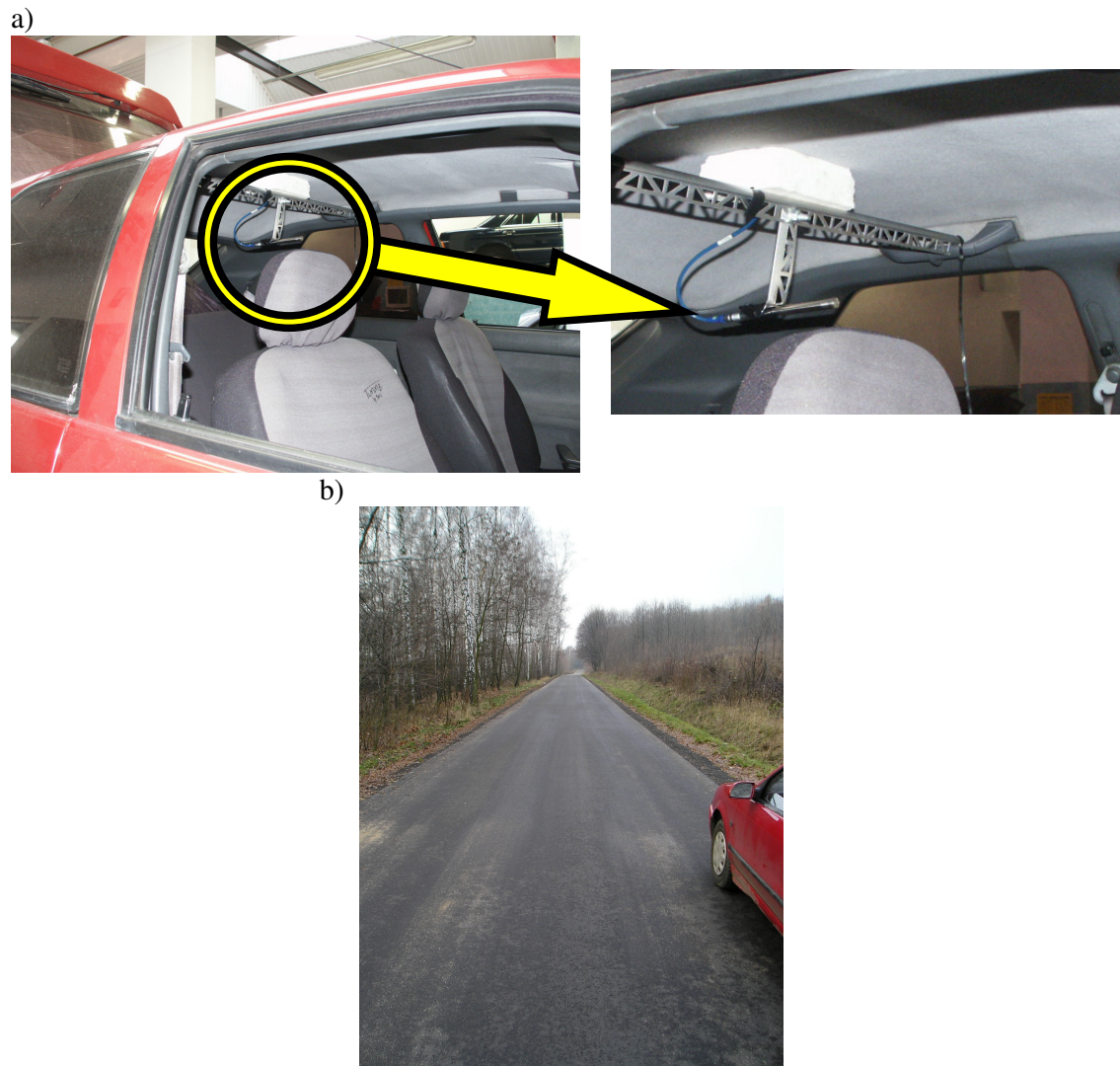
Rys. 1. Miejsce umieszczenia mikrofonu pomiarowego (a), odcinek drogi, na którym dokonywano pomiarów (b)
