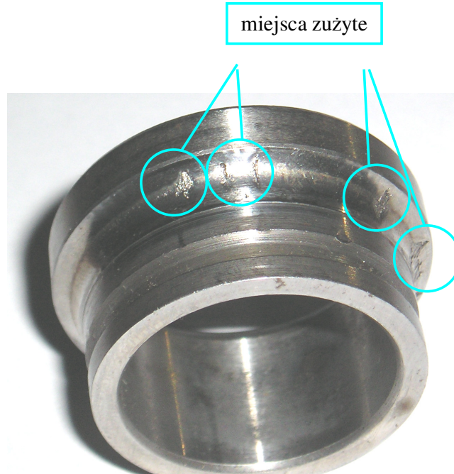
Rys. 4. Zużycie eksploatacyjne łożyska lewego tylnego koła jezdnego
