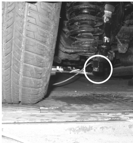
czujnik mas nieresorowanych – mocowanie na wahaczu, unsprung mass sensor – coaptation on control arm
