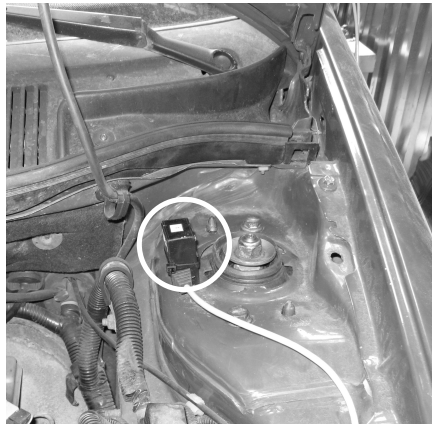
czujnik mas resorowanych – górny kielich amortyzatora, sprung mass sensor – upper shock absorber socker
