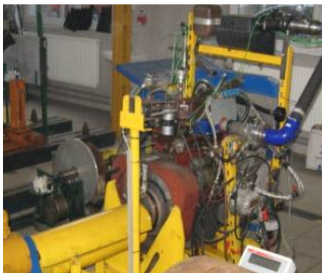
Rys. 3. Silnik PERKINS AD3.152G na hamowni silnikowej
