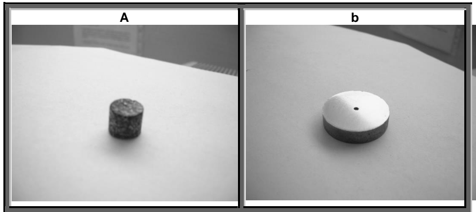
Rys. 2. Próbkę (A) i przeciwp próbka (b) zastosowane w badaniach Fig. 2. Specimen (A) and counter – specimen (b) used in tests
