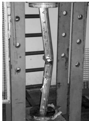
Rys. 11. Próba ściskania wzmocnienia WZ2 Fig. 11. Compression test of strengthening WZ2
