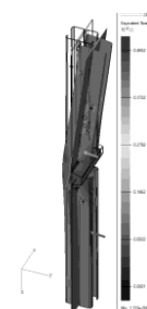
Rys. 22. Wzmocnienie WZ1: odkształcenia
