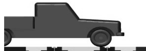
Fig. 4. Visualization of railway crossing in MSC VisualNastran 4D system Rys.4. Ujęcie pojazdu w czasie symulacji (1 – wjazd przedniego koła na płytę, 2 – zjazd przedniego koła z płyty)
