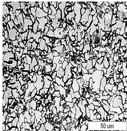
Fig. 16. Microstructure in HAZ Rys. 16. Mikrostruktura w SWC
