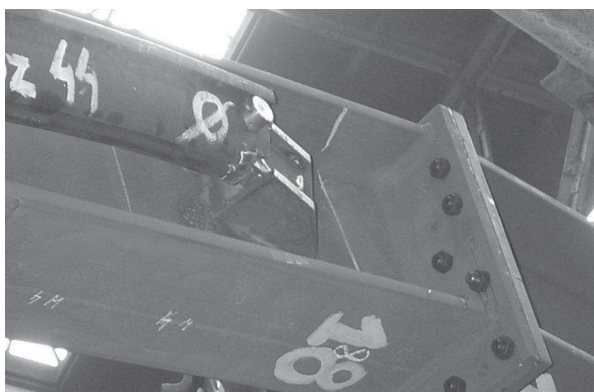
Fot. 3. Specjalne ucho do mocowania odrzwi do belki pod ostrym kątem (fot. M. Rotkegel)
