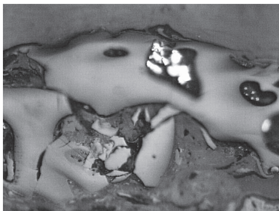
Fot. 4. Piryt (najjaśniejszy) w przestrzeniach komórkowych inertynitu
