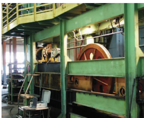
Fot. 1. Zestaw aparatury do pomiaru zmian sił w linie podczas badania zmęczeniowego w maszynie P4-GIG-2
