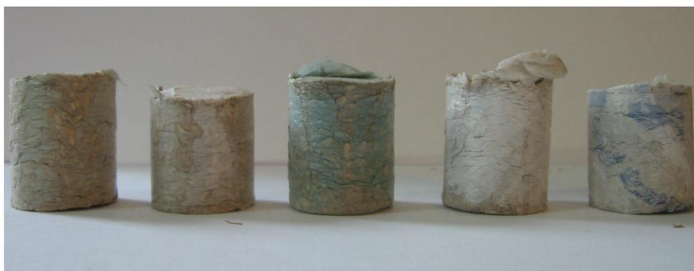
Rys. 2.2. Brykiety ze słomy pszenżyta i PE-LD nie rozdrobnionego. 1 – 68 MPa, 200°C; 2 – 95 MPa, 200°C; 3 – 82 MPa, 190°C; 4 – 82 MPa, 200°C; 5 – 82 MPa, 210°C [5, 6].
