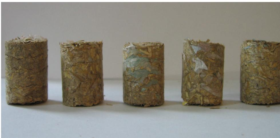
Rys. 2.1. Brykiety ze słomy pszenżyta i PE-LD rozdrobnionego. 1 – 68 MPa, 200°C; 2 – 82 MPa, 200°C; 3 – 95 MPa, 200°C; 4 – 82 MPa, 190°C; 5 – 82 MPa, 210°C [5, 6].
