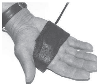
Fot. 2. Zamocowanie przetwornika typu A3R do wewnętrznej strony ręki
