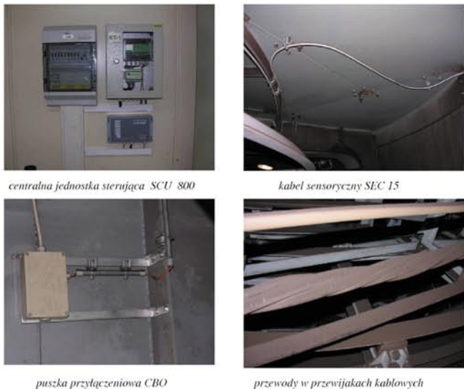
Rys. 5. Elementy podsystemu LiST zabudowane w pomieszczeniu przewijaków kablowych koparki SRs 2000 nr 36 w KWB Belchatów Fig. 5. Elements of LiST subsystem located in a cable winding room in excavator SRs 2000 No. 36 in Belchatów Brown Coal Mine.
