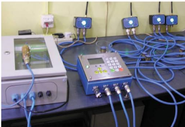
Rys. 6. Elementy podsystemu bezprzewodowych czujników temperatury w czasie badań laboratoryjnych Fig. 6. Elements of wireless heat detectors subsystem during laboratory tests
