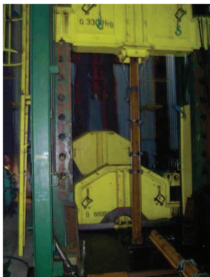
Fot. 1. Złącze kształtowników w stanowisku badawczym
