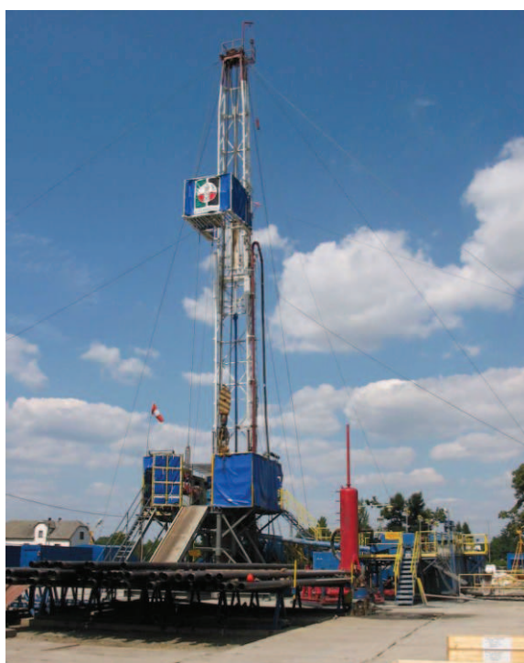
Fot. 1. Otwór badawczy do wtłaczania CO 2 do pokładu węgla (program RECOPOL)
