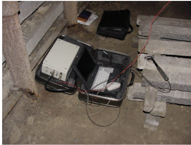
Fot. 1. Przenośny system akwizycji i rejestracji funkcji przejścia – PSAR-FRF; realizacja badań w warunkach rzeczywistych stosowania samodzielnej obudowy kotwiowej
