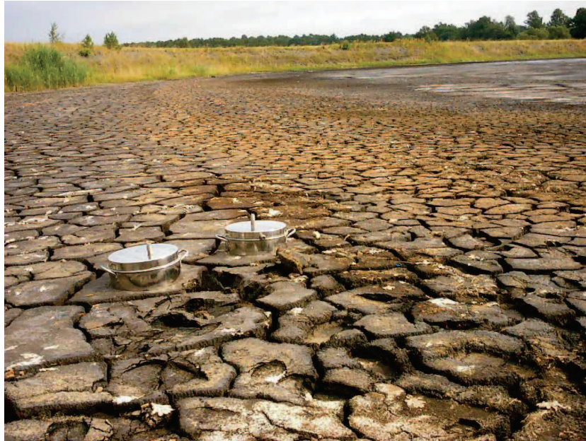
Fot. 2. Pomiar ekshalacji radonu w opróżnionym osadniku kopalnianym
