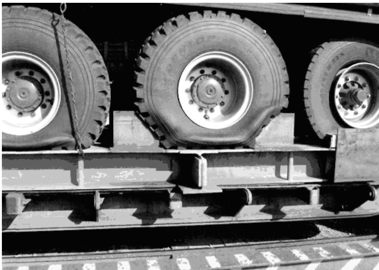
Fig. 3. Pressure reduction of wheel machinery wheels on a flat car Рис. 3. Снижение давления колёс колёсной техники на платформе
