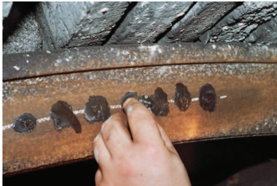
Fot. 5. Pomiar grubości ścianki kształtownika V metodą pośrednią (fot. M. Rotkegel) Phot. 5. Measurement of V-section wall thickness with the indirect method (phot. by M. Rotkegel)
