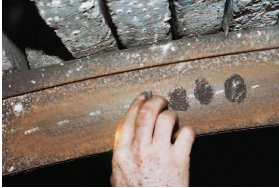
Fot. 4. Wykreślenie linii pomiarowej i naniesienie substancji (fot. M. Rotkegel) Phot. 4. Plotting of measuring line and substance spreading (phot. by M. Rotkegel)
