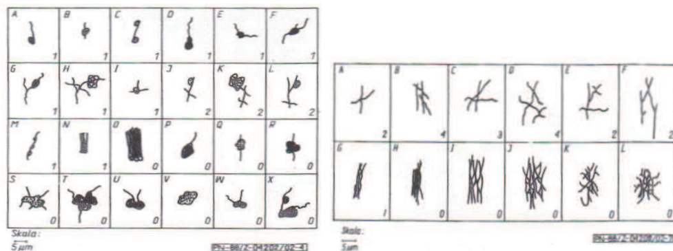
Rys. 4. Wybrane wzorce włókien i pęków włókien azbestu według PN-88/Z-04202
