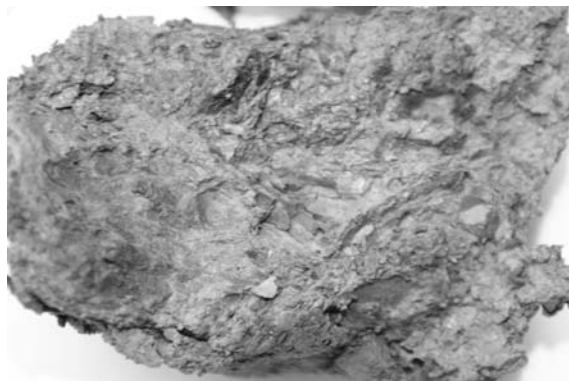
Fot. 1. Fragment próbki łożupki z możliwością pomiaru kąta nachylenia lamin \alpha pochodzącego z terenów osuwiskowych w rejonie budowanego zbiornika wodnego w Świnnej Porębie
