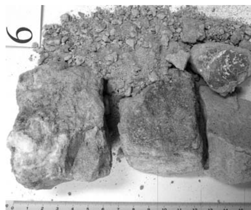
Rys. 3. Piaskowiec słabo zwięzły z wyraźnymi śladami utlenienia siarczków miedzi
