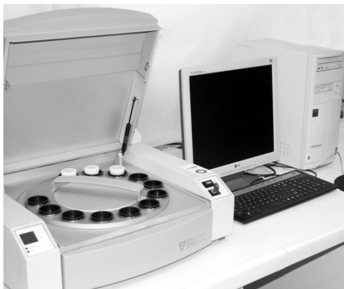
Fot. 2. Widok spektrometru rentgenowskiego MiniPal PW4025. Laboratorium Katedry Techniki Wodno-Mułowej i Utylizacji Odpadów Politechniki Koszalińskiej
