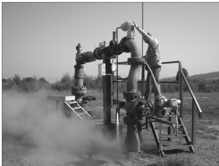
Rys. 6. Bańska Nizna – otwór eksploatacyjny wód termalnych z warstw triasowych dla potrzeb Geotermii Podhalańskiej (fot. M. Ciosmak 2007)
