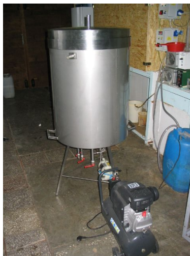
Rys. 1. Model reaktora beztlenowego o przepływie pionowym w warunkach laboratoryjnych
