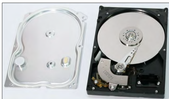
Fot. 2. Dysk HDD po usunięciu blachy wierzchniej
