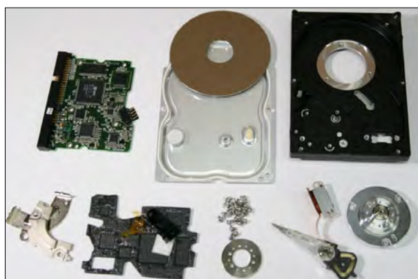
Fot. 4. Wydzielone podzespoły dysku po kompletnym demontażu
