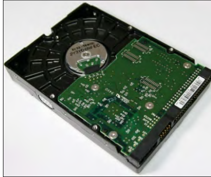
Fot. 1. Przykładowy dysk HDD 3,5” widok od strony elektroniki (J. Szałatkiewicz)
