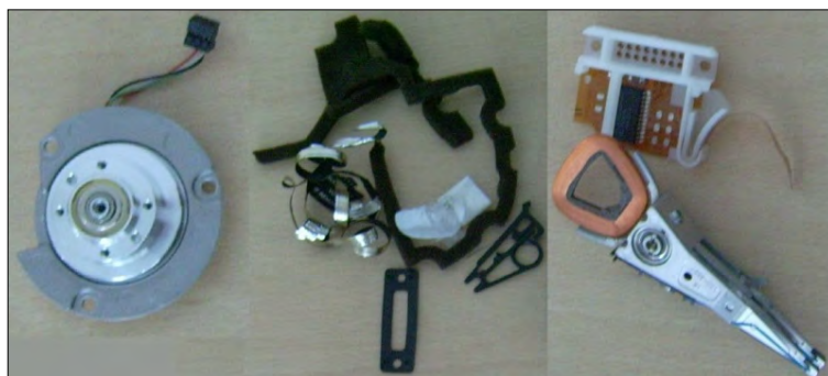
Fot. 5. Przykładowe pozostawione w całości podzespoły HDD, ujęte w kategorii „Podzespoły inne”
