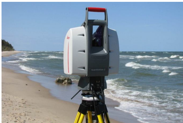
Rys. 2. Skaner ScanStation 2 firmy Leica wykorzystany w pomiarach klifu Fig. 2. Leica ScanStation 2 used in cliff survey
