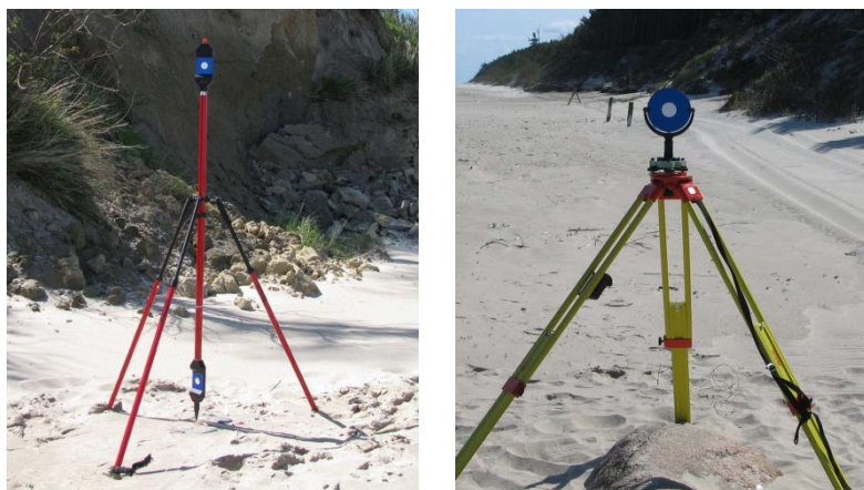
Rys. 3. Przykładowa sygnalizacja punktów łączących dla poszczególnych chmur punktów (ScanWorld)
