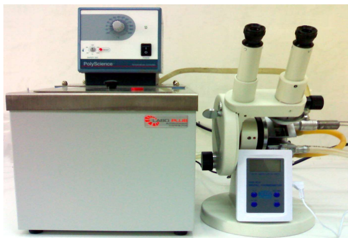
Rys. 7. Refraktometr Abbe AR2 wyprodukowany przez “A. KRÜSS Optronic” Fig. 7. Abbe refractometer, model AR2 manufactured by “A. KRÜSS Optronic”
