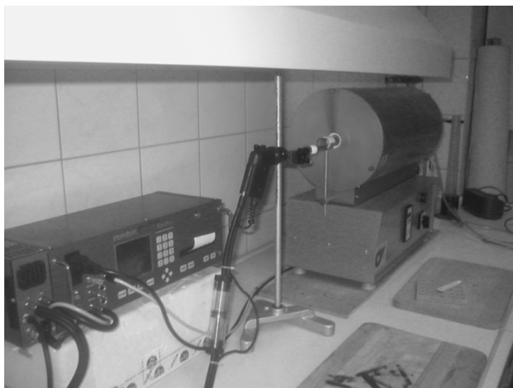
Fig. 3. Experimental stand for investigations of waste incineration process Rys. 3. Instalacja do badania procesu spalania odpadów
