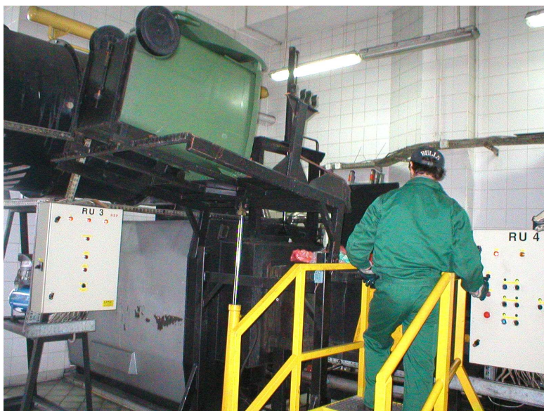
Rys. 2. Układ automatycznego załadunku odpadów szpitalnych
