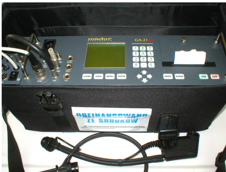
Rys. 7. Przenośny analizator gazów spalania GA-21 plus Fig. 7. Mobile incineration gas analyser GA-21 plus
