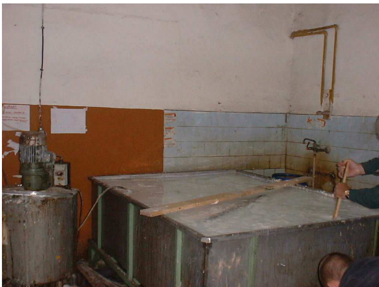
Rys. 2. Zbiornik na ścieki pochodzące z płukania instalacji dozującej klej Fig. 2. Tanks for wastewater from installation of glue dosing
