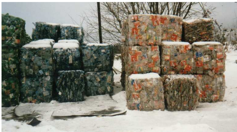
Rys. 10. Odzyskane surowce typu „PET” sprasowane waga kostki około 75 kg Fig. 10. Pressed recycled materials of PET type, cube weight of about 75 kg
