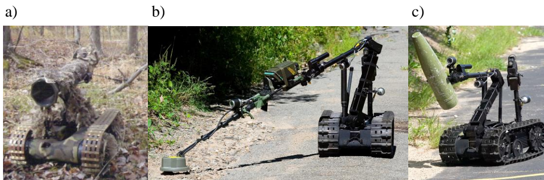
Rys. 7. Robot Talon Mk II z wyposażeniem dodatkowym a) 84 mm granatnik przeciwpancerny AT-4; b) zestaw do rozpoznania; c) robot do identyfikacji i neutralizacji pułapek bombowych
