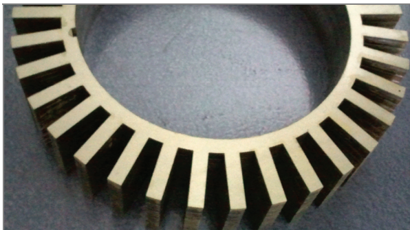
Rys. 4. Sklejony rdzeń stojana
