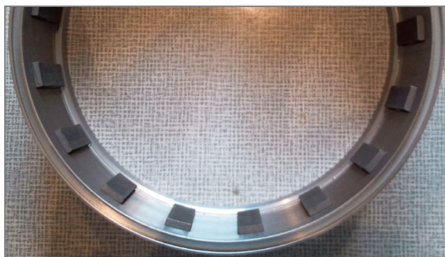
Rys. 6. Klejenie magnesów do korpusu wirnika Fig. 6. Gluing the magnets to the body of the rotor
